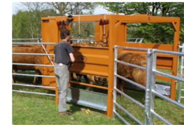
■ L'éleveur actionne les portes en toute sécurité à l'abri des animaux grâce aux commandes déportées sur le côté du châssis, à l'extérieur du parc.
