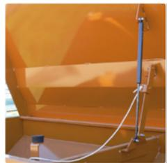
■ **Relevage du toit assisté** par un vérin à gaz. La manipulation du toit est facilitée et sécurisée. (Béquille simple sur JBS 20045 et JBS 25052)
