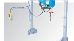
■ Treuil électrique arrière 500 kg à position réglable et potence porte-outil : CCPT340.
