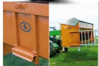
■ **Attelage 3 points renforcé** ou fourreaux de fourche (pour les modèles les plus volumineux). Transport possible sans démonter le parc (à vide - 25 km/h max).
