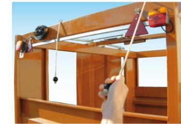
■ Ouverture rapide des portes d'une simple action sur le loquet grâce à un vérin à gaz. (Ouverture télécommandée à distance (30 m) disponible en option)
