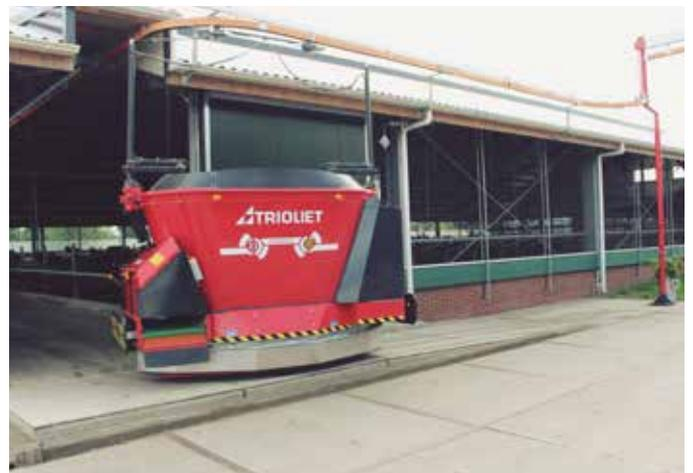
Peut se déplacer jusqu'à 1 mètre à droite et à gauche du rail électrique
