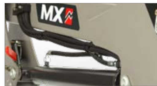
Discrets, les flexibles hydrauliques et le faisceau électrique en polyuréthane passent sous le bras du chargeur. Protégés, ils restent propres et faciles d'accès.
