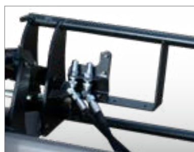
Accès facile à la 3ème fonction pour les outils nécessitant une alimentation hydraulique.
