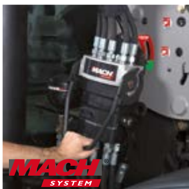
Connexion électro-hydraulique instantanée tracteur ↔ chargeur › page 50
