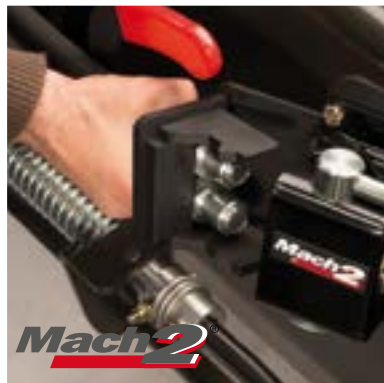
Connexion hydraulique instantanée chargeur ↔ outil › page 50
