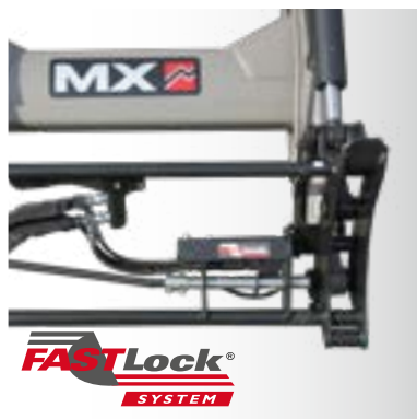
Attelage/dételage automatique des outils et des fonctions hydrauliques et électriques › page 48
