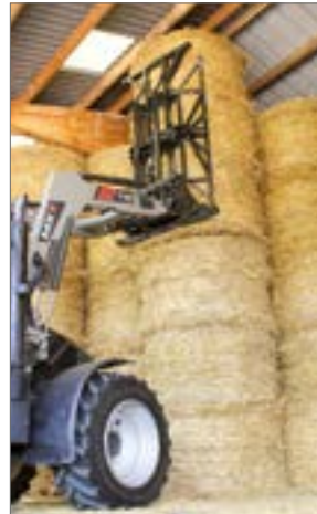
Doigts repliables pour le transport
