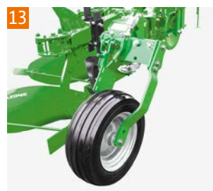
Roue pneumatique Ø 600 mm x 220 mm de large – modèle compact (double bras) Disponible pour : toutes les charrues 6 socs et 5 socs S et/ou V
