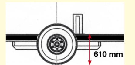
**Hauteur au sol réduite pour faciliter la dépose de la coupe**
