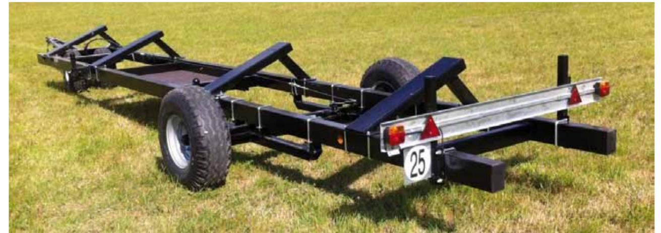
La tourelle intégrée sous le chariot avec une rotation à 120° et la position de l'essieu arrière avancée permet à la coupe de suivre la moissonneuse-batteuse parfaitement dans ses traces même dans les courbes les plus étroites...
