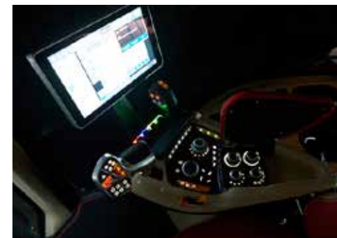
Les icônes de tous les interrupteurs sont rétro-éclairées lorsque les phares sont allumés.
