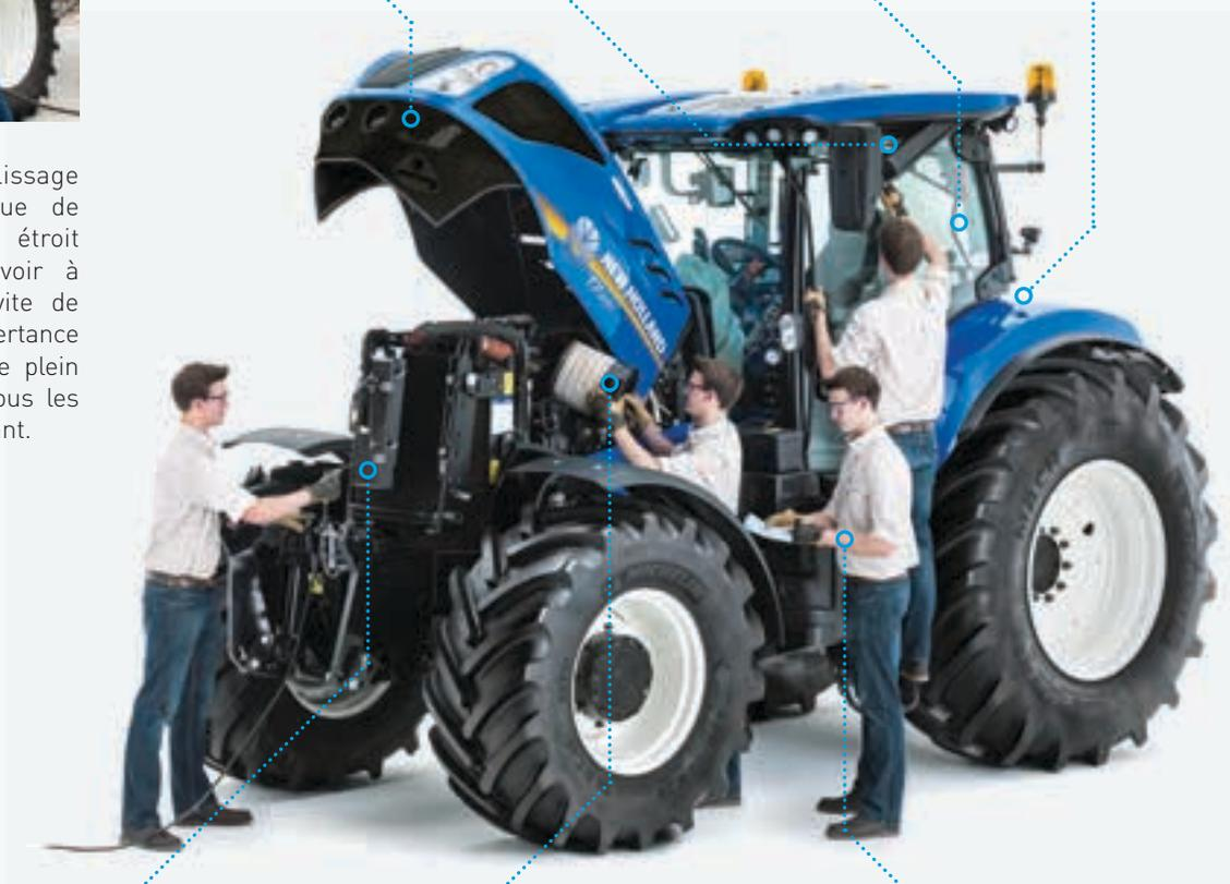
Le système de refroidissement s'ouvre vers l'avant pour un nettoyage plus rapide et plus facile.
