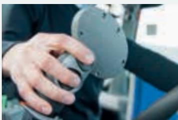
Le bouton derrière la poignée CommandGrip™ permet le contrôle de fonctions supplémentaires.
