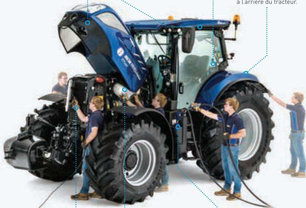
Le système de refroidissement s'ouvre vers l'avant pour un nettoyage plus rapide et plus facile.
