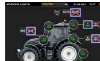
Configurez facilement les phares de travail avec l'écran tactile de 9 pouces. Les phares de travail Premium et Premium+ incluent également des feux de virages réglables, qui sont commandés par le capteur d'angle de braquage dans le pont avant.
