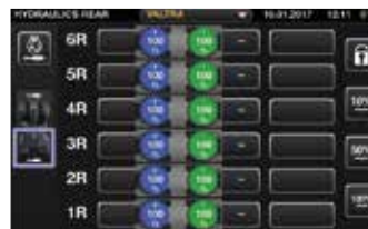
Vous pouvez attribuer une commande pour actionner une fonction hydraulique, y compris les distributeurs hydrauliques avant et arrière, les relevages avant et arrière et le chargeur frontal.
