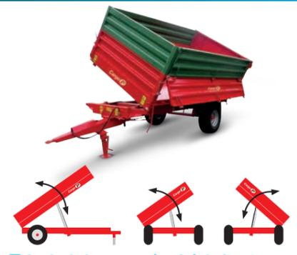
Angle de bannage sécurisé droite et gauche par un distributeur piloté
