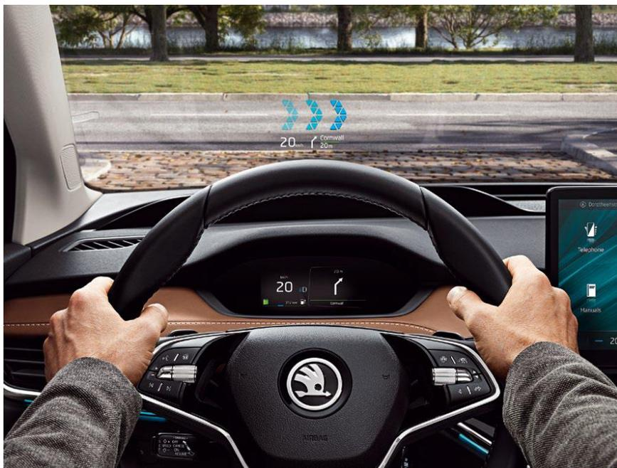
L'affichage tête haute avec réalité augmentée permet d'afficher la vitesse, la navigation, les aides à la conduite et les panneaux de signalisation.
