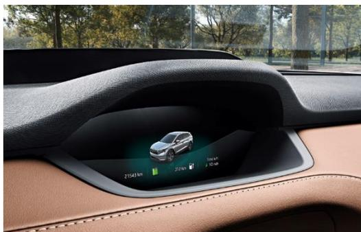
Combiné d'instruments de 5,3" exclusivement numérique offrant 4 vues différentes. Possibilité de modifier les vues via un bouton sur le volant.
