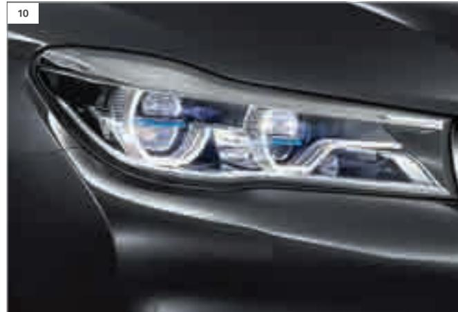
**[ 08 ]** Le Pack Advanced Full LED avec projecteurs directionnels et feux de route permanents anti-éblouissement « BMW Selective Beam » offre un éclairage optimal en toutes circonstances et une meilleure visibilité par rapport aux systèmes traditionnels.
