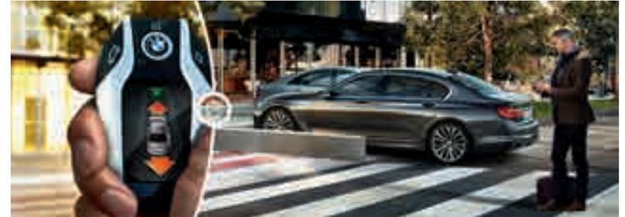
La **fonction de stationnement autonome télécommandé<sup>2</sup>** permet au conducteur de sortir tranquillement de sa voiture, puis de garer celle-ci à distance en marche avant sur un emplacement ou dans un garage étroit. Le conducteur active la fonction en dehors de la voiture par le biais de la clé intelligente « BMW Display Key ».
