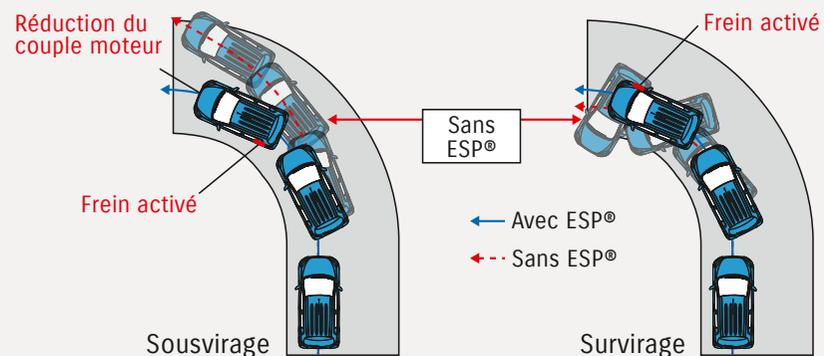
Si l'ESP® détecte une perte d'adhérence sur une roue (par exemple lorsque le conducteur surbraque brusquement), il intervient instantanément sur le couple moteur et sur les freins pour rétablir l'adhérence et aider le conducteur à garder la maîtrise de la direction.
