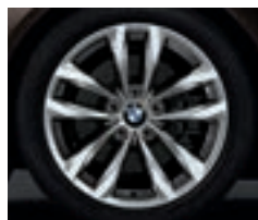
Jantes en alliage léger 18" (46 cm) style 609 à rayons doubles, monte pneumatique mixte RSC permettant le roulage à plat. Dimensions : 8 J x 18 à l'avant, pneumatiques 245/45 R 18 ; 9 J x 18 à l'arrière, pneumatiques 275/40 R 18.
