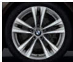
Jantes en alliage léger 19" (48 cm) style 610 à rayons doubles, bicolores, avec pneumatiques RSC permettant le roulage à plat. Dimensions : 8,5 J x 19, pneumatiques 245/40 R 19.
