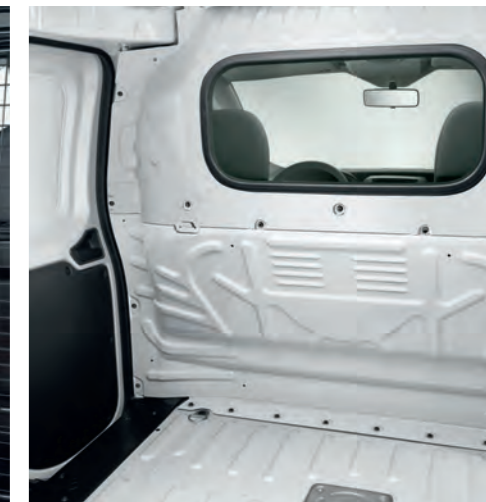
Cloison de séparation vitrée
