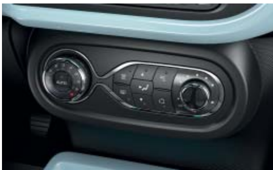
Climatisation régulée (disponible dans le Pack Confort)
